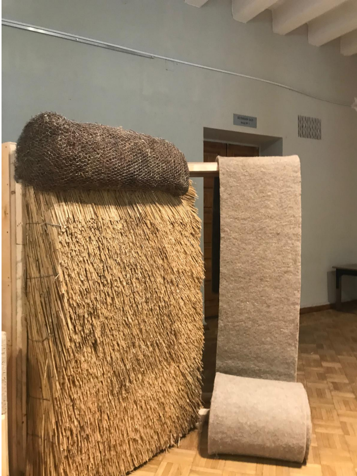
Reed und Hanfisolierung
