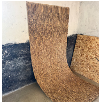
Abb. 25: Flexible Reetplatte, stark formbar, vielseitig einsetzbar
