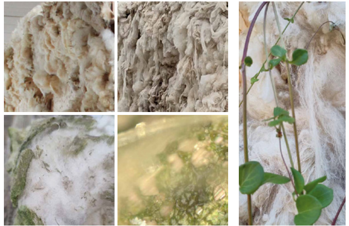
Abb. 7: Detail Rohwolle mit witterungsbedingt veränderter Oberfläche © FK Wollbau, S.134 | Abb. 8: Struktur der Rohwolle als Rankgerüst © FK, Wollbau, S. 135
