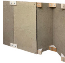
Abb. 22: Wandelement aus Lehm und Jute mit Verbindungsmitteln © Leon Zimmermann / Institut für Architekturbezogene Kunst, TU Braunschweig
