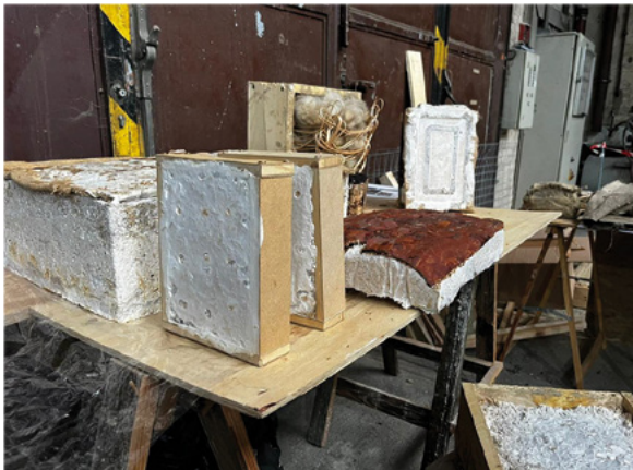
Abb. 18 und 19: Proben zur Messung, wie gut ein Material Wärme leitet, ZNE! Berlin 2023 und TU Braunschweig © IBEA, Tobias Pörschke
