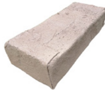
Abb. 24: fertiger Lehm-Dämmstein © Leon Zimmermann / Institut für Architekturbezogene Kunst, TU Braunschweig
