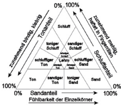
Abb. 4: Bestandteile von Lehm © https://lehm-in-farbe.de/was-ist-lehm/
