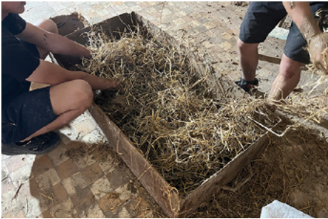
Abb. 4–6: Schritte der Herstellung von Hanfbausteinen © HOPE HOME - НАДІЯ
