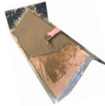
Abb. 21: Lehm getränkte Jutesäcke auf Schalung und fertiges Element © Leon Zimmermann / Institut für Architekturbezogene Kunst, TU Braunschweig
