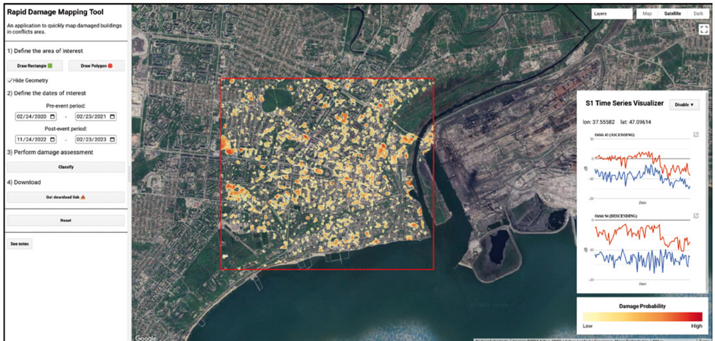
Abb. 15: Prototypisches Dashboard des Rapid Damage Mapping Tools, mit Schadensschätzungen für eine Region in Mariupol und Visualisierung der Sentinel-1-Zeitreihen. (Quelle: O. Dietrich et al. 2025, ETH Zürich); https://arxiv.org/pdf/2406.02506
