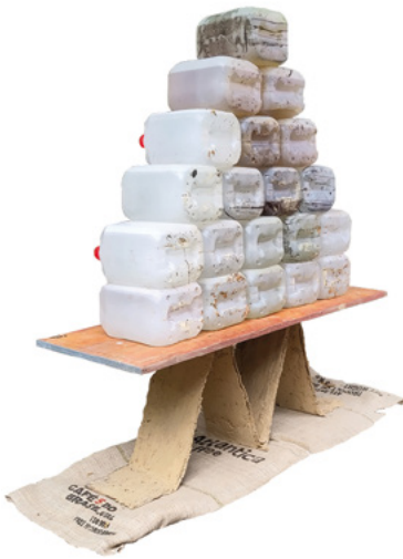
Abb. 20: Belastungstest einer Woll-Lehm-Jute Faltung mit über 230 kg © Leon Zimmermann/ Institut für Architekturbezogene Kunst, TU Braunschweig
