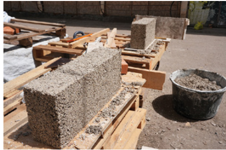
Abb. 4–6: Schritte der Herstellung von Hanfbausteinen © HOPE HOME - НАДІЯ
