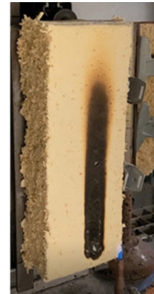
Abb. 7: Brandprüfungen nach EU-Norm mit dem Ergebnis, dass nur die äußere Schicht des Mycels brennt, während der innere Teil nicht angegriffen wird © Pohl et al. (2022) Fungal Biol Biotechnol 9 | Schmidt et al. (2023) Fungal Biol Biotechnol 10
