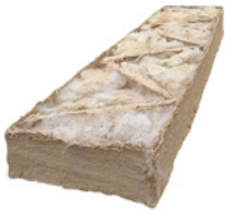
Abb. 23: Mit Rohwolle gedämmter Baustein aus Lehm-Jute Faltung © Leon Zimmermann / Institut für Architekturbezogene Kunst, TU Braunschweig
