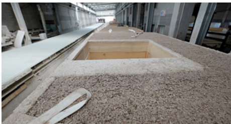
Abb. 21: Aus Hanf und Kalk vorgefertigte Wände, Auslassung für ein Fenster © www.hanfstein.eu
