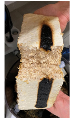
Abb. 7: Brandprüfungen nach EU-Norm mit dem Ergebnis, dass nur die äußere Schicht des Mycels brennt, während der innere Teil nicht angegriffen wird © Pohl et al. (2022) Fungal Biol Biotechnol 9 | Schmidt et al. (2023) Fungal Biol Biotechnol 10
