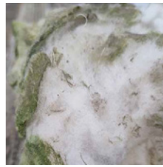
Зоб. 7: Деталь сирієї вовни зі зміненою внаслідок погодних умов поверхнею © FK Wollbau, с. 134 | Рис. 8: Структура сирієї вовни у вигляді шпалери © FK Wollbau, с. 135
