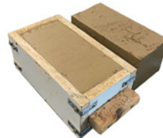
Зоб. 25: Глиняна цегла в опалубці та вимкнена © Леон Ціммерманн / Інститут будівельного конструювання, ТУ Брауншвейг
