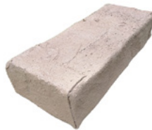
Зоб. 24: Готовий глиняний ізоляційний блок © Леон Ціммерманн / Інститут мистецтва, пов'язаного з архітектурою, ТУ Брауншвейг
