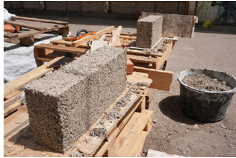
Зоб. 4–6: Етапи виробництва будівельних блоків з конопель © NOPE HOME · НАДІЯ
