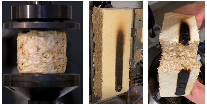
Зоб. 7: Випробування на вогнестійкість згідно зі стандартами ЄС, які показують, що горить лише зовнішній шар міцелію, тоді як внутрішня частина залишається неушкодженою. © Pohl et al. (2022) Fungal Biol Biotechnol 9 | Schmidt et al. (2023) Fungal Biol Biotechnol 10
