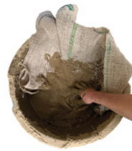
Зоб. 19: Мішечок для кави, просочений глиною © Леон Ціммерманн / Інститут мистецтва, пов'язаного з архітектурою, ТУ Брауншвейг
