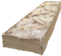
Зоб. 23: Будівельний блок з глиноджуту, складений та ізолюваний необробленою вовною © Леон Ціммерманн / Інститут мистецтва, пов'язаного з архітектурою, ТУ Брауншвейг
