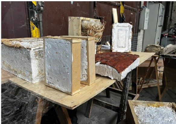
Зоб. 18, 19: Зразки для вимірювання теплопровідності матеріалу, ZNE! Берлін 2023 та TU Braunschweig © IBEA, Тобіас Першке
